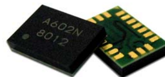
写真：製品「AMI602N」 (寸法4.2×6.2×1.1mm)
