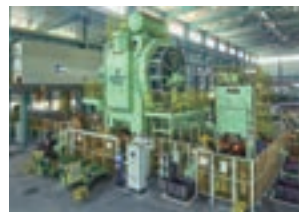
SAFCのクランクシャフト用5000トン全自動鍛造プレスライン
