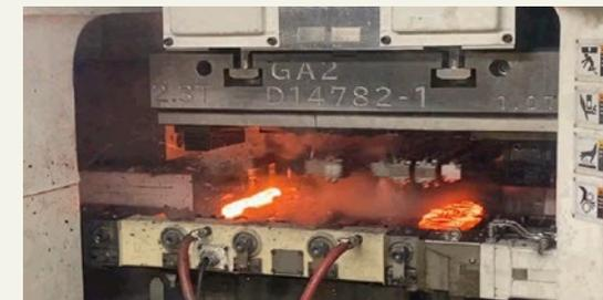
鍛造コンロッドライン稼働の様子
