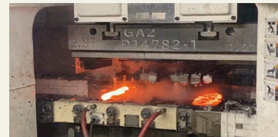
鍛造コンロッドライン稼働の様子
