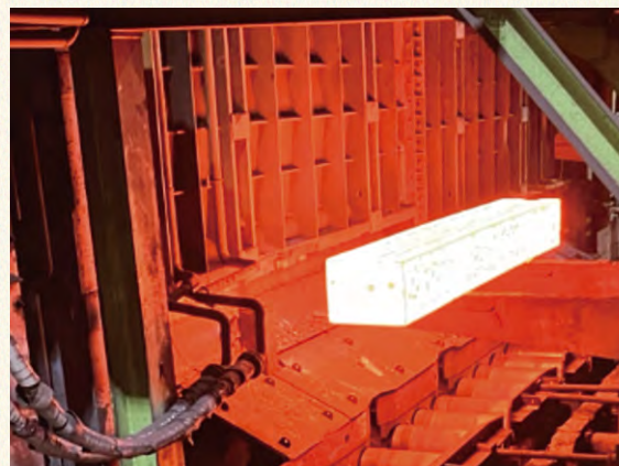
加熱炉からの抽出写真
