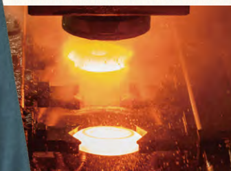
リングギヤの高速自動鍛造ライン
