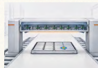
高感度磁気センサを用いた異物検査イメージ図
