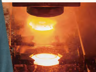
リングギヤの高速自動鍛造ライン
