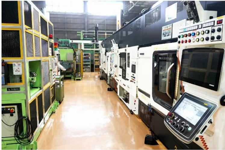
機械加工（切削）・冷間鍛造・機械加工（仕上げ）を一貫で実施する全自動ライン
