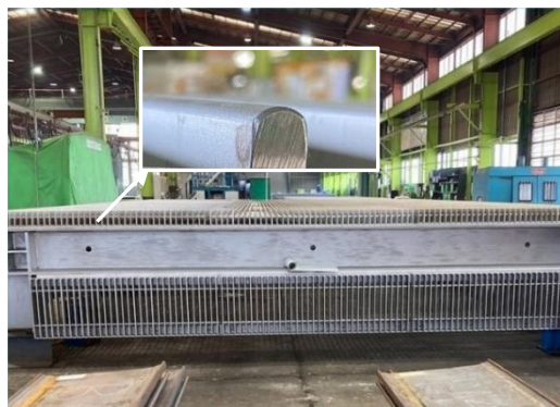
南摩ダム選択取水設備スクリーン
