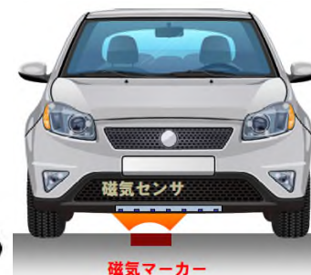
【磁気レーンマーカの原理】
