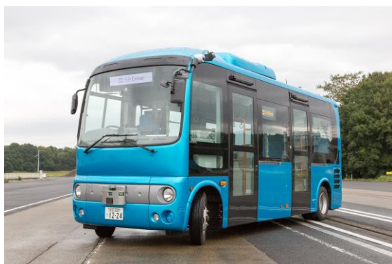
日野自動車製ポンチョをベースとした実験用自動運転バス(先進モビリティ所有)
