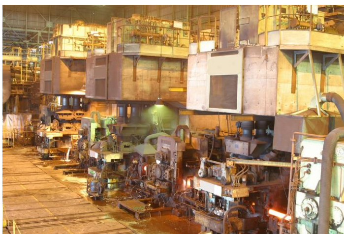
稼働する第2棒鋼圧延工場の圧延ライン
