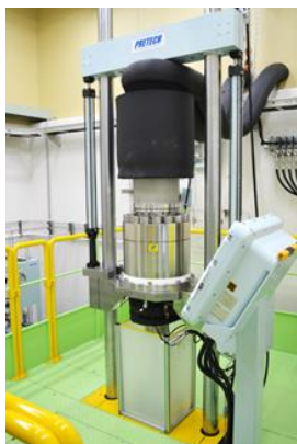
図1. 高圧水素ガス環境試験に対応した 軸荷重型の引張・疲労試験装置 (2019年導入)
