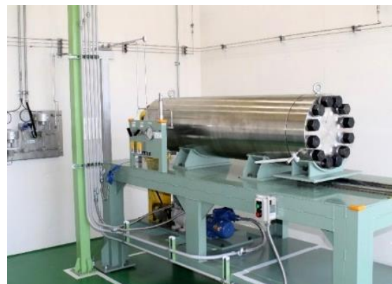
図2. 高圧水素ガス環境試験に対応した 回転曲げ疲労試験装置＜世界初＞ (今回導入)
