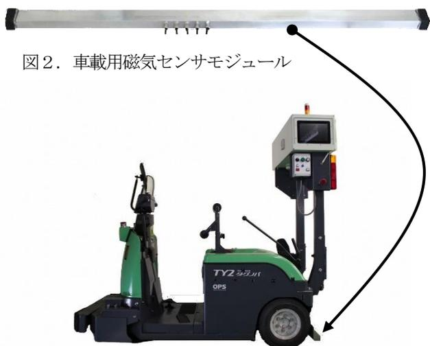
図2. 車載用磁気センサモジュール
